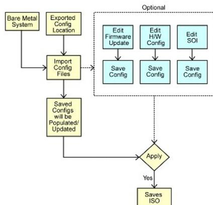
**ANMERKUNG:** Wenn Sie die Konfigurationsdatei importieren, sind alle Felder der GUI ausgefüllt. Sie können die Module zur Konfiguration der Firmware-Aktualisierung, der Hardware und der SOI nach Bedarf bearbeiten. Stellen Sie hierbei jedoch sicher, dass Sie keine Änderungen auf dem Bildschirm "Auswahl von Systemen" vornehmen; sollten Sie dies tun, wird die gesamte vorhandene Konfiguration für die drei Module zurückgesetzt.
